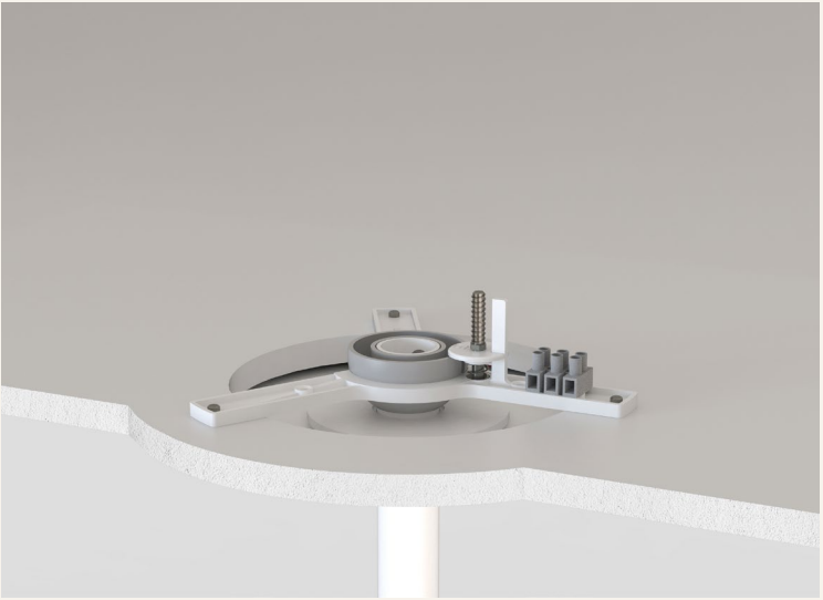
2. Intégration du système et fixation du ventilateur
