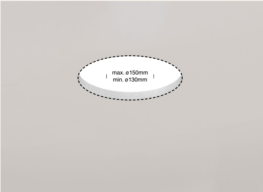
1. Préparation du plafond
